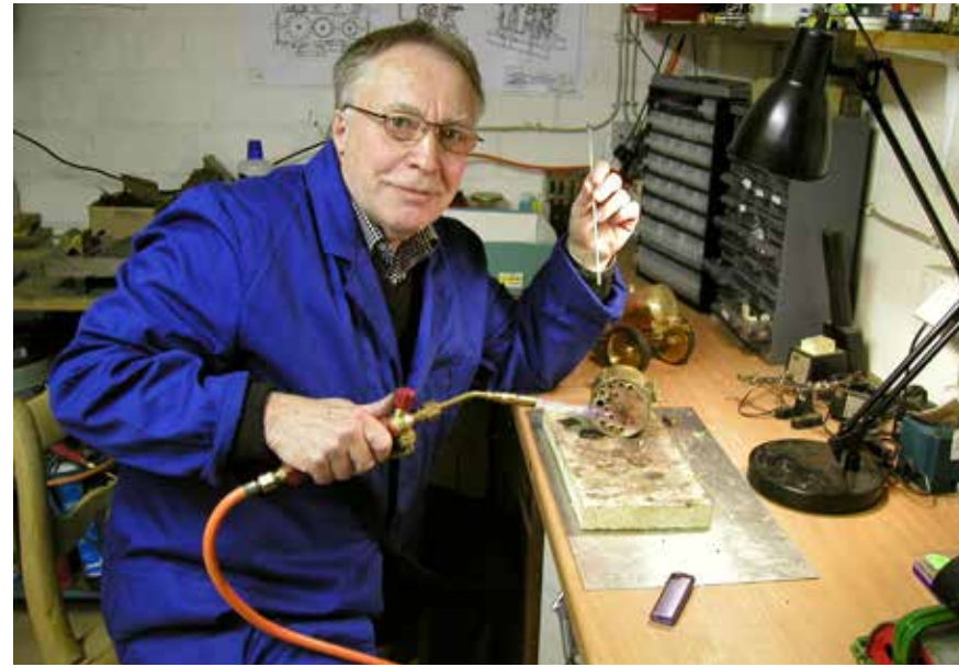
Bernd Eikermann lötet in seiner Werkstatt an einem Dampfkessel.
